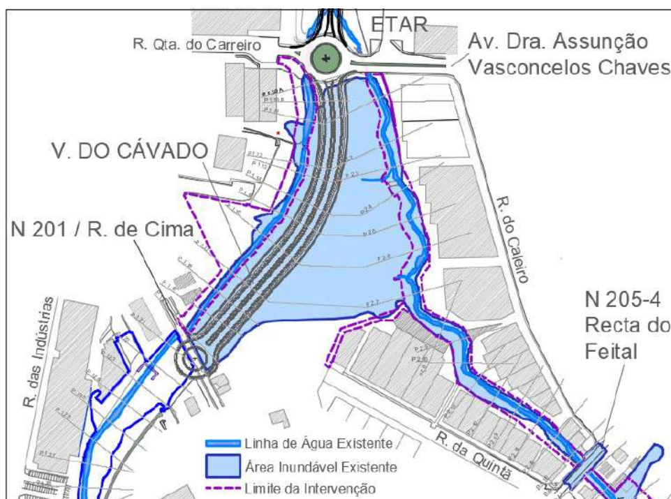
Figura 3.3 – Delimitação da área Inundável – Troço 2, zona jusante entre a ETAR e a EN 205-4 – situação existente. Do lado esquerdo da imagem está o Troço 3.
